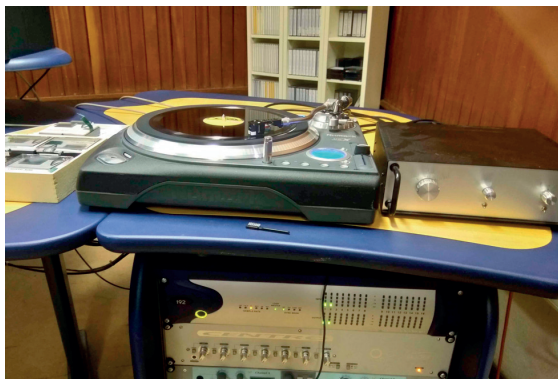
Setup general de transcripción de discos (Numark TTX, Preamp flat, Digidesign HD192)
