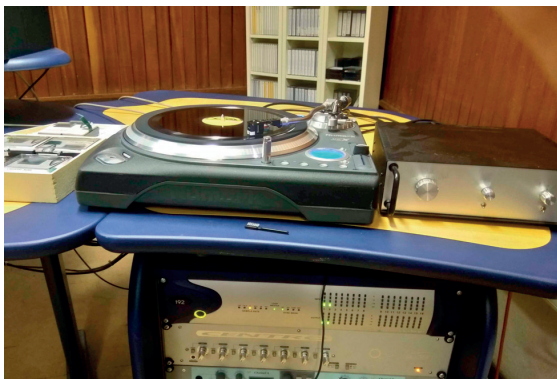
Setup geral de transcrição de discos (Numark TTX, Preampl flat, Digidesign HD192)
