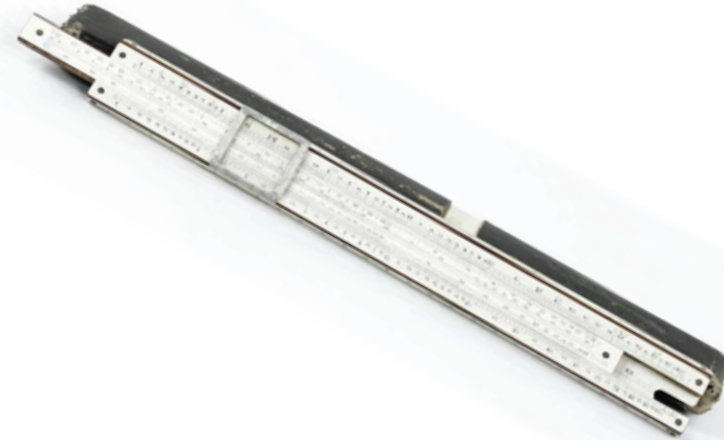
Regla de cálculo para navegación, autoría de Ramón Fontenla, que se conserva en el Real Observatorio de la Armada
