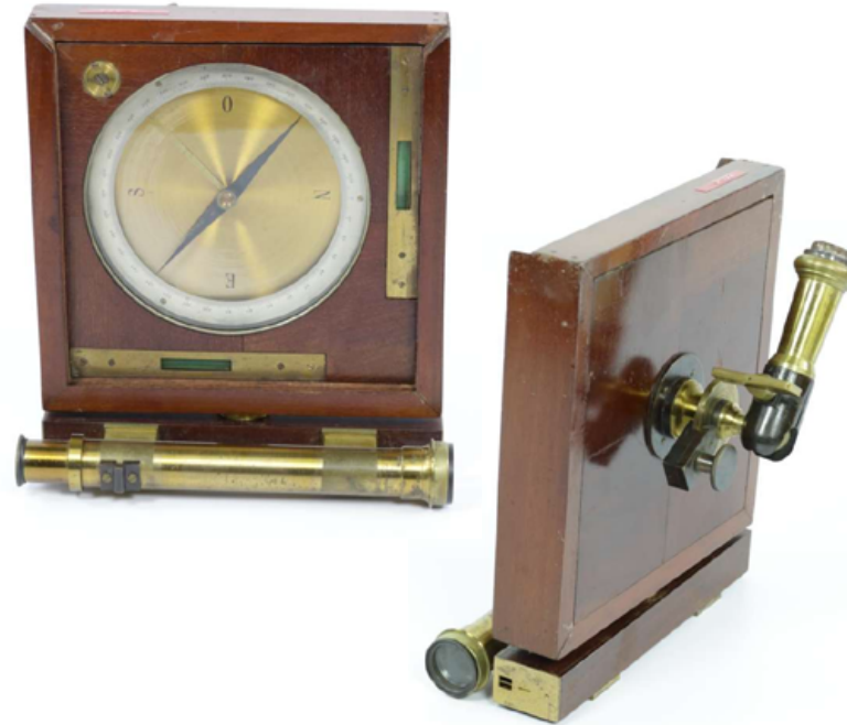
Brújula con nivel realizada por Baleato que se conserva en el Real Observatorio de la Armada
