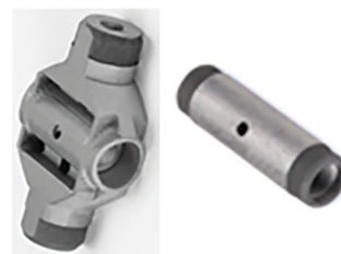
Figura 7. Tubo de grafito de quen-tamento transversal (esquerda) e lonxitudinal (dereita). Volumes de mostra: 20-100 µL.
