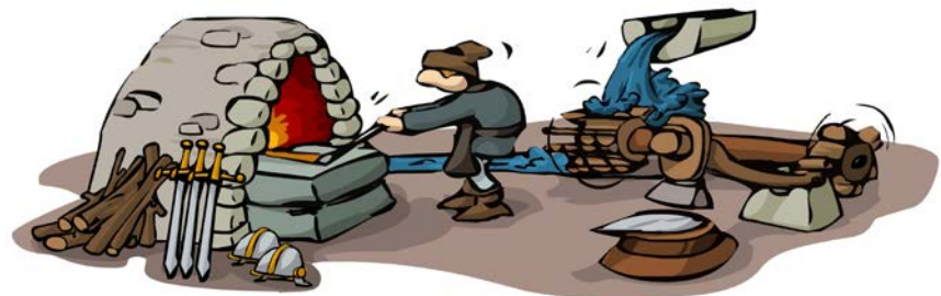
Imagen 3: Representación de los dos procesos claves en la industria de la forja hidráulica: golpeo de la maza sobre la aleación de carbono y hierro y obtención del carbón vegetal mediante combustión y del hierro fundido.
