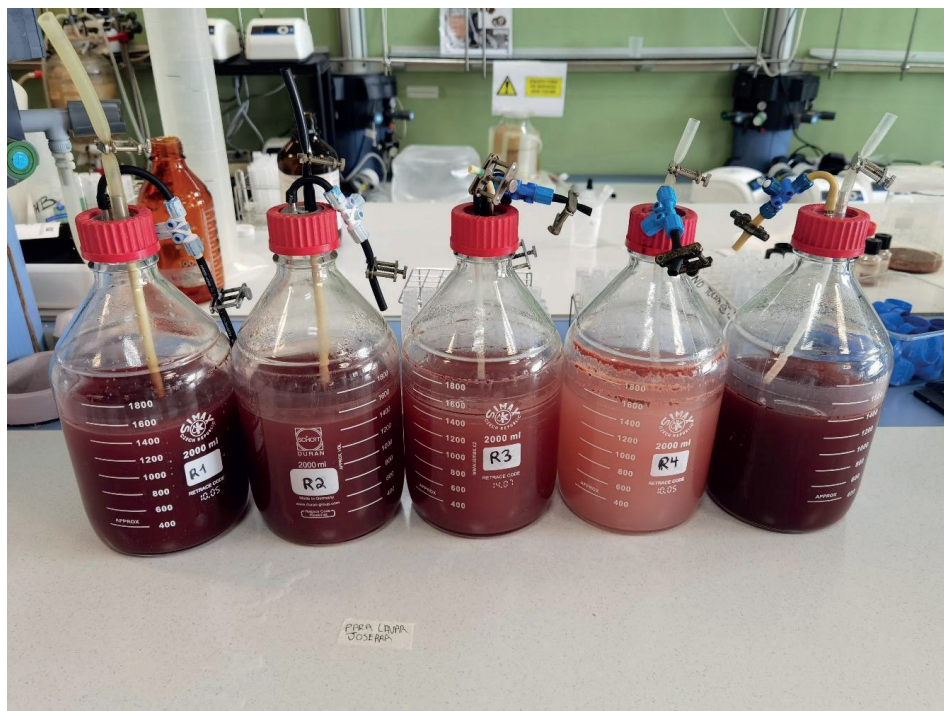
Figura 1: Reactores empregados durante a experimentación sometidos a diferentes condicións de salinidade.
