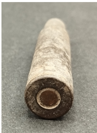
Fig. 4. Vaíña de latón dun cartucho 7 x 57 mm tipo Mauser procedente do Convento de Santa Clara (Pontevedra). Fáltalle o proxectil a pesar de que non parece estar percutido. A utilización deste tipo de cartuchos difundíuse no Estado cara 1893 e mantívose incólume ata a década dos corenta. Museo de Pontevedra.
