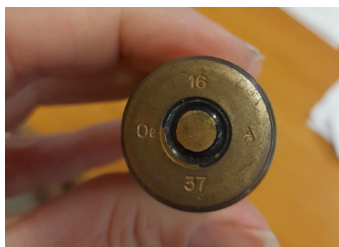
Figs. 6 e 7. Disparo completo do calibre 20 x 110 Swiss Oerlikon (Oe) do ano 1937 (37), fabricado en Alemaña, en Altdorf (A). O 16 pode facer referencia ao calibre ou á procedencia do metal. A cor negra do proxectil indica que é de tipo perforante.
