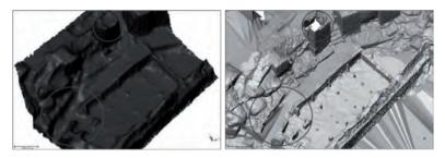
**Figura 10**. Diferencias entre las mallas calculadas a partir de los datos obtenidos con UAV (a) y TLS (b).
