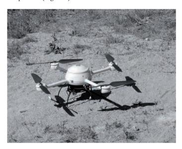
Figura 2. Plataforma UAV Microdone md 4-200.
