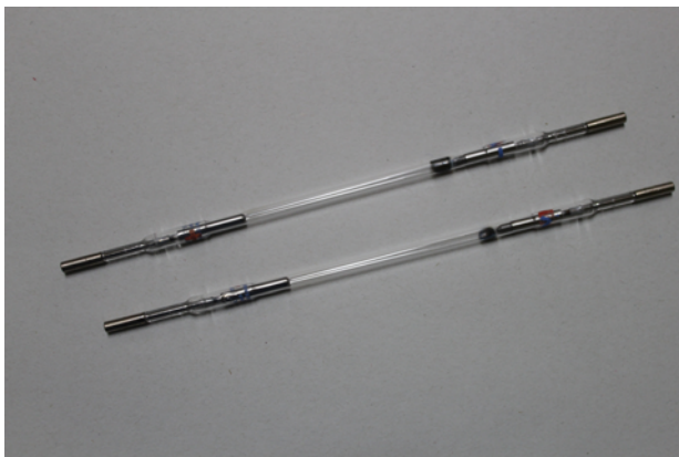
Figura 3. Lámpadas de arco de luz branca usadas para bombear un láser tipo Neodimio (cristal dopado con Nd)
