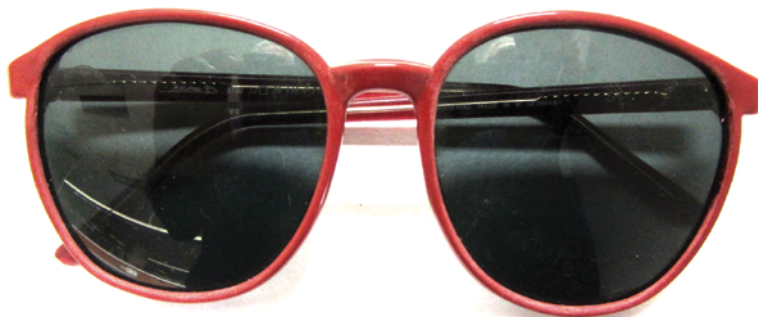
Figura 1.1.2: A lente do ollo esquerdo está xirada da súa posición correcta na dirección das agullas do reloxo. Pode verse a diferenza na zona nasal superior dos aros.
