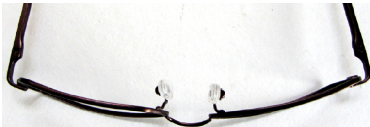
Figura 1.1.3: Ponte excesivamente curvada
