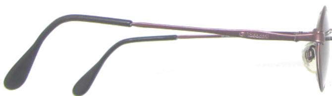
Figura 1.2.2: A bisagra da patilla que vemos diante está torcida
