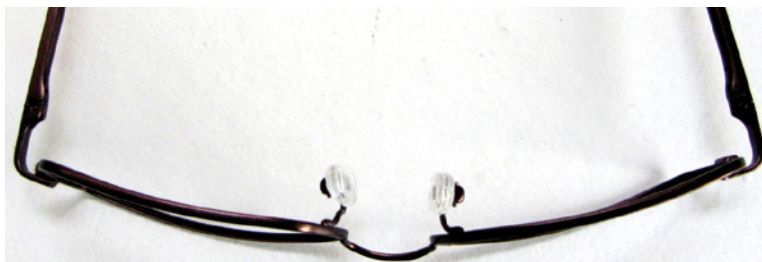
Figura 1.1.3: Ponte excesivamente curvada
