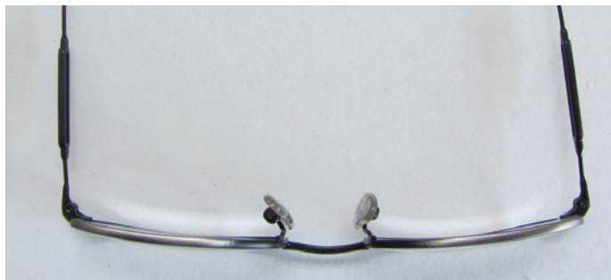
Figura 1.2.1: O aro da dereita está moi curvado polo que a patilla se pecha demasiado. Cómpre abrir o talón
