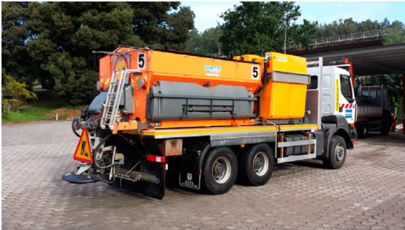
Figura 1.11: Combi equipado con fundente líquido e sólido
