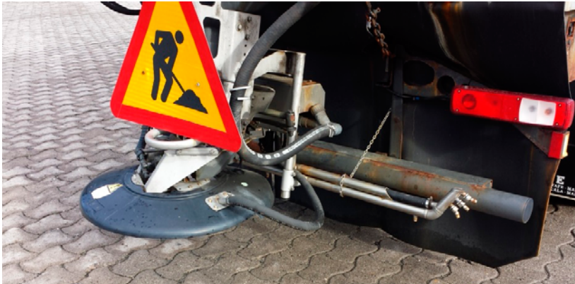
Figura 1.10: Mecanismo espallador de fundente sólido
