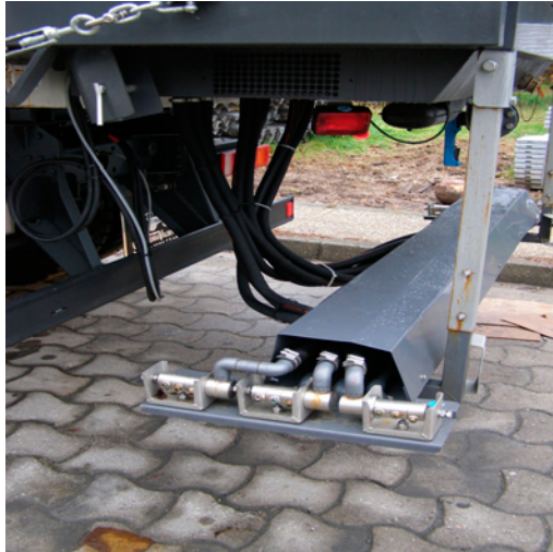
Figura 1.9: Mecanismo espallador de fundente líquido
